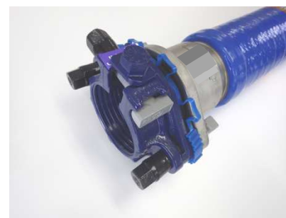
樹脂管受口(記号:VU・SU・PU) 離脱防止金具付 VU:塩ビ管・鋼管 SU:JISポリ管・SUS管 PU:配水用ポリエチレン管
