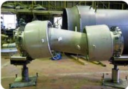
可とう管入れ替え時、既存変位に合わせ 中間パイプに角度を付け、更なる変位を 可能にした製品
